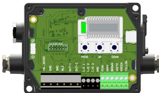
Zielona płyta elektroniki w modułach LT, LThot, LTex i G5.
